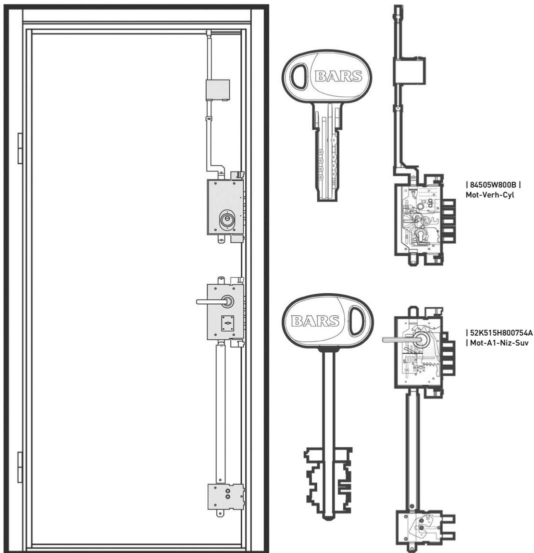
BARS MOTTURA 52K515. Нижний сувальдный замок сейфового типа без функции перекодировки
